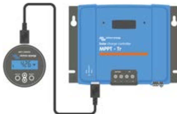
Verbind het beeldscherm met de zonnelader via een VE.Direct-kabel.
