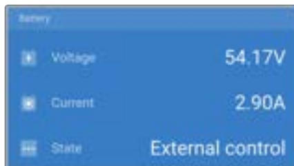
De VictronConnect-app geeft aan dat de lader extern wordt aangestuurd.
