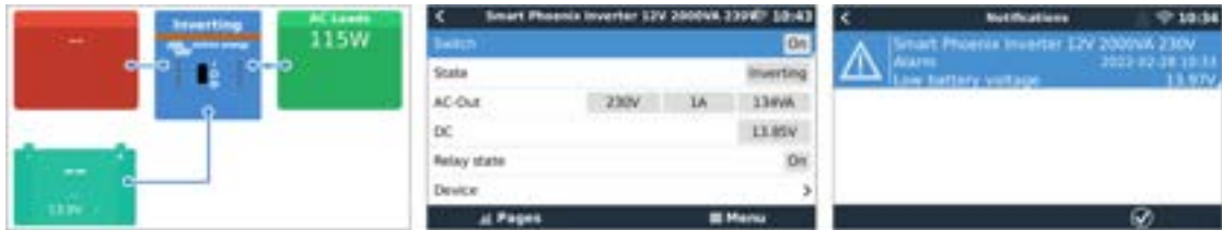
Voorbeeld van GX-schermen van links naar rechts: systeem scherm, scherm omvormerapparaat en een alarmmelding.
